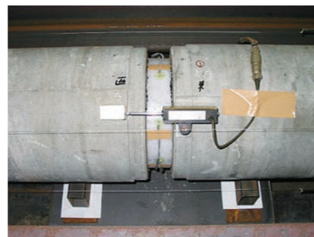
耐震性確認(抜き出し試験)
