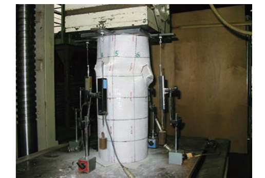
耐震性確認(座屈試験)
