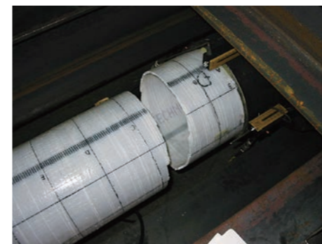
耐震性確認(引張り試験)
