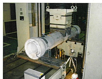
ヒューム管を更生した インシチュフォームの曲げ試験
