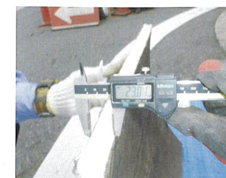
写真-6 厚み測定状況
